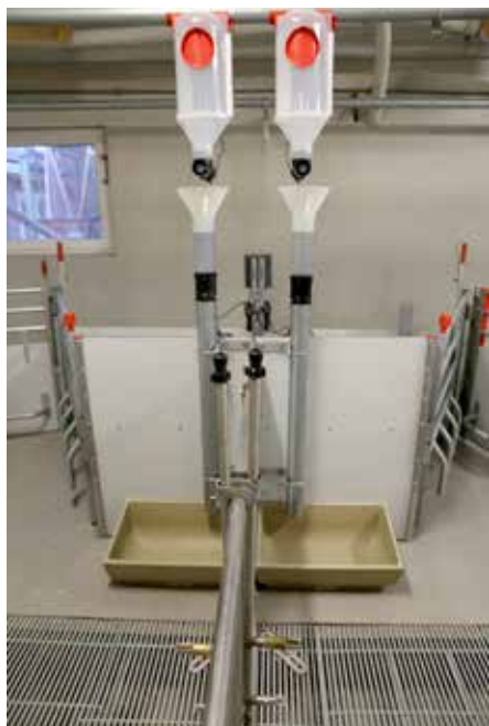
LUFT: Detaljer fra nedløpene i det trykkluftdrevne fôringsanlegget. Bildene er tatt i et annet grisehus, men viser anlegget slik det skal monteres.
